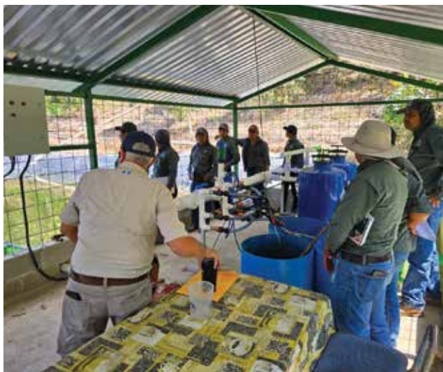
Capacitación a técnicos de región VI, en inyección de fertilizantes con ventury vía fertirriego. Finca San Lorenzo, Salamá.
