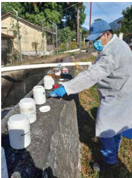
Monitoreo del efluente de aguas especiales procedentes del beneficiado húmedo del café.
