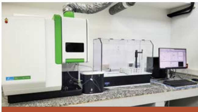
ICP AVIO 550 Max para análisis multielemental.
