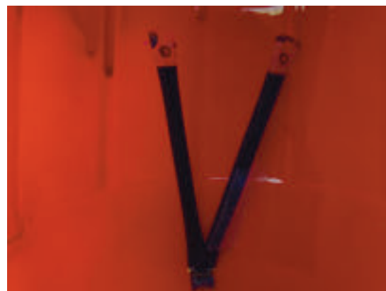
No.4 Pajilla de 6 cc sellada en los extremos con 2 orificios de 2 cc.
