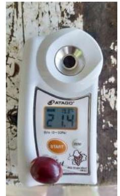
*Medición de grados brix con refractómetro digital.*
