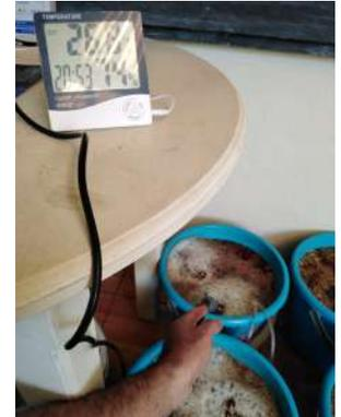
*Medición de temperatura y humedad relativa ambiental con termohigrómetro.*
