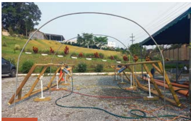
Secadora solar tipo túnel con compuertas hidráulicas.
