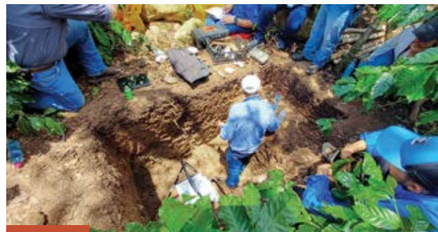
Caracterización de la calicata del suelo candidato como material de referencia.
